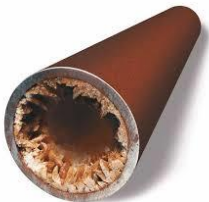
Рис.1 Солеобразование в эксплуатационных колоннах. Рост отложений карбоната кальция более 40% проточной области.
